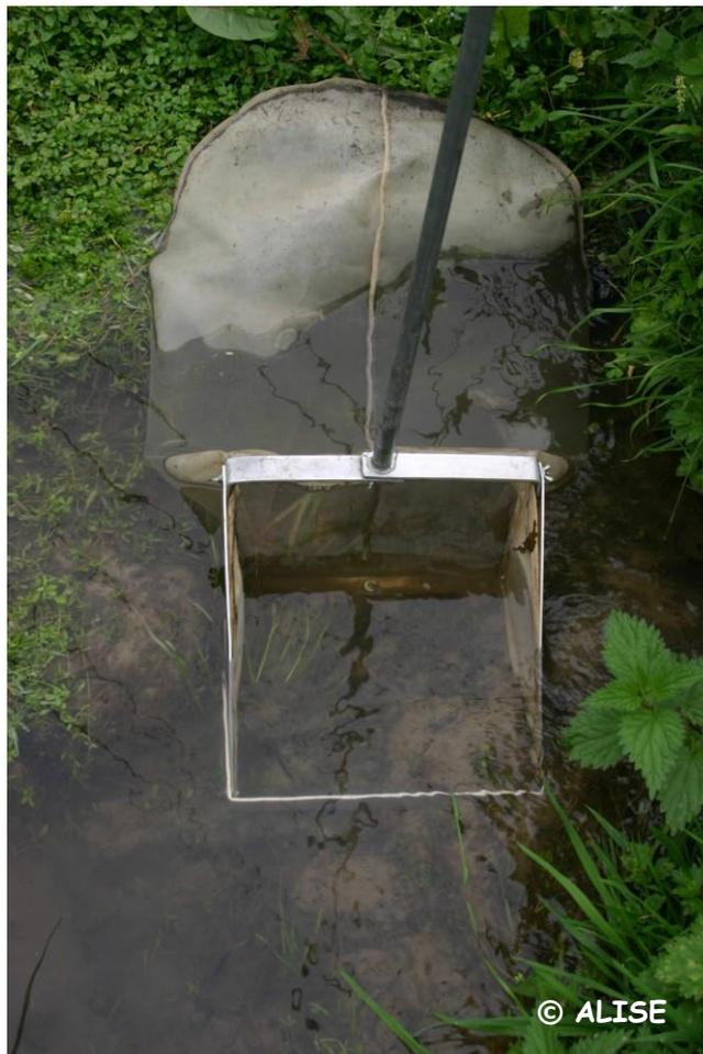
**Photo 1 : Prélèvement à l'aide d'un Surber**
